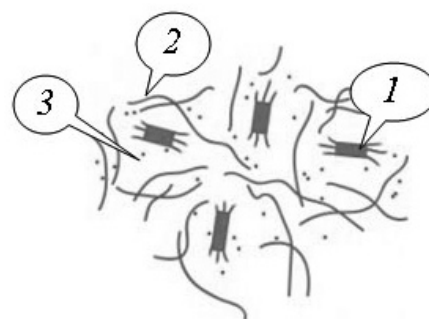
Рис. 8. Схематичное представление модели геля водной суспензии коллоидов дезинтегрированной БЦ: 1 – коллоид, 2 – фрагменты неупорядоченных цепей БЦ, 3 – молекулы воды
