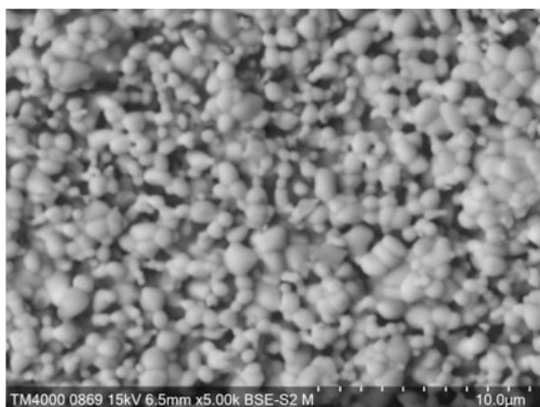
Рис. 2. СЭМ-изображение поверхности пористой керамики (\text{Pb}_{0,9}\text{Ba}_{0,1})(\text{Zr}_{0,9}\text{Ti}_{0,1})\text{O}_3
