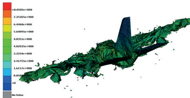
Рис. 2. Разрушение самолета при столкновении с недеформируемой преградой в момент времени t = 0,5 с, полученное методом конечных элементов
